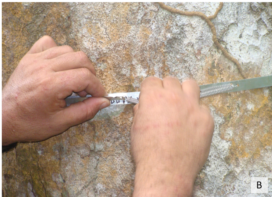
Figura 3. Montagem (A) e ajustes (B) das cintas dendrométricas na altura do DAP da árvore. Senador Guiomard, AC, 2008–2014.
