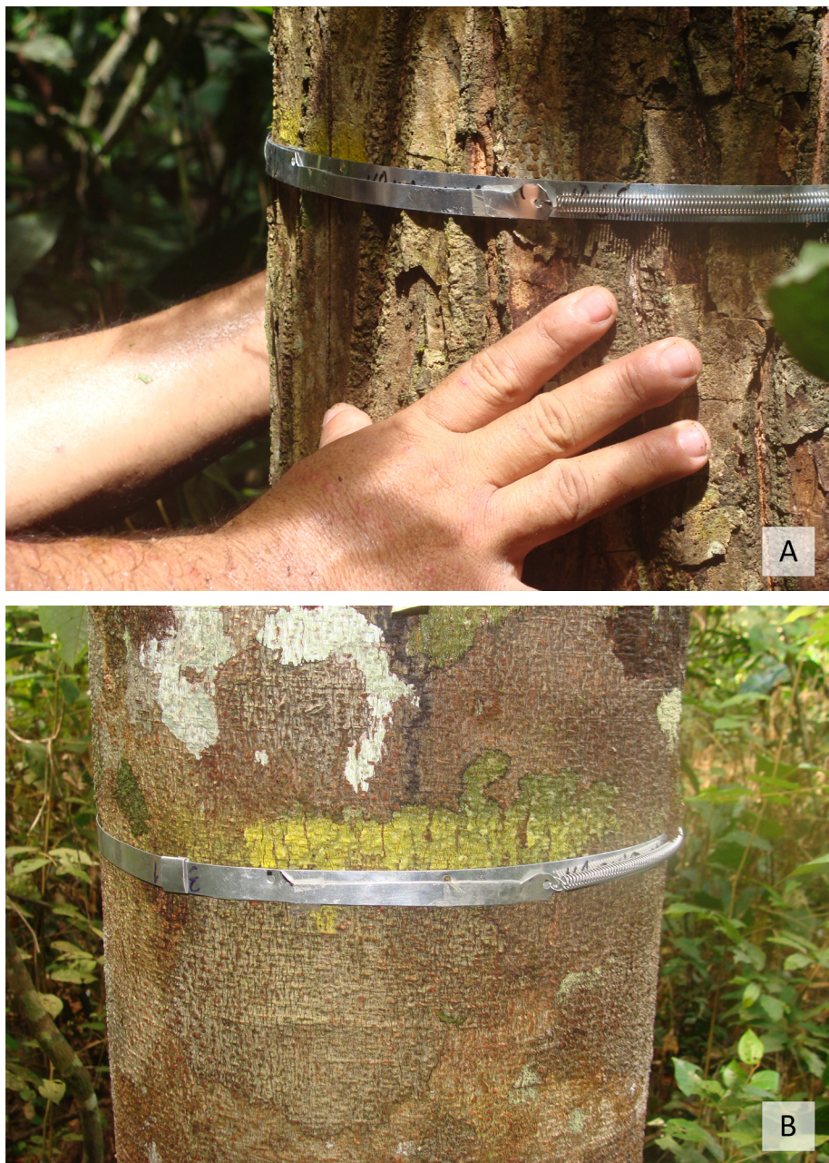
Figura 4. Cinta dendrométrica instalada (A) e ajustada (B) na altura do DAP da árvore, pronta para a medição. Senador Guimard, AC, 2008–2014.
