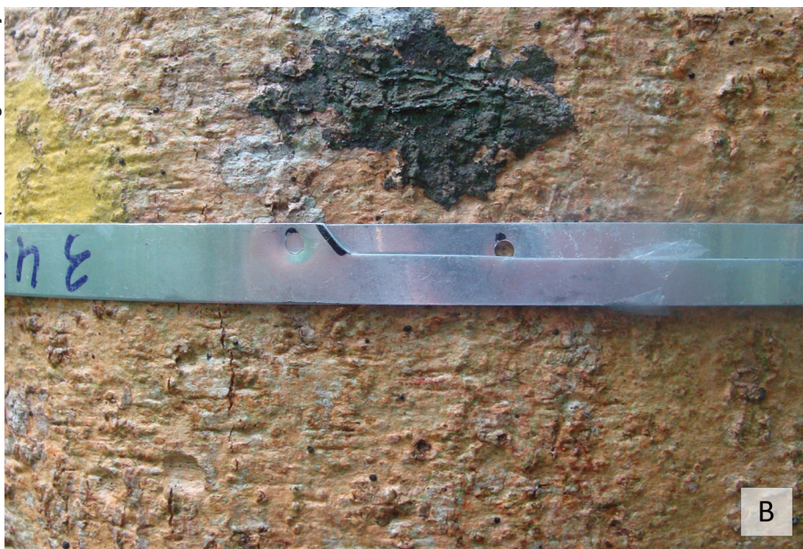
Figura 5. Medição com paquímetro (A) da distância entre os orifícios (pontos de medição) e detalhe dos orifícios (B) das cintas dendrométricas. Senador Guiomard, AC, 2008–2014.
