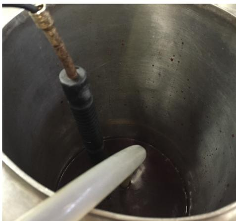
**Figura 3.** Processo de concentração por osmose inversa das antocianinas da água residual do processamento de frutos de juçara.
