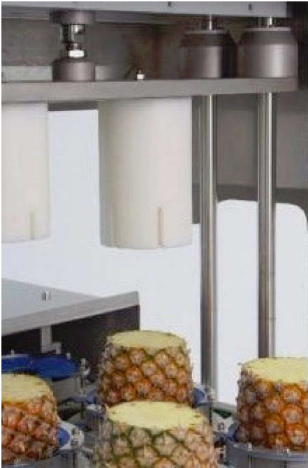
Figura 3. Ginaca, equipamento para retirar a casca e o centro de abacaxis durante o processamento.
