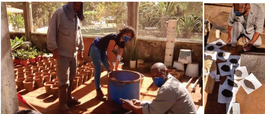
**Figura 8.** Mistura dos nutrientes e teores do fino de carvão à lama de rejeito. Sete Lagoas, 2016.
