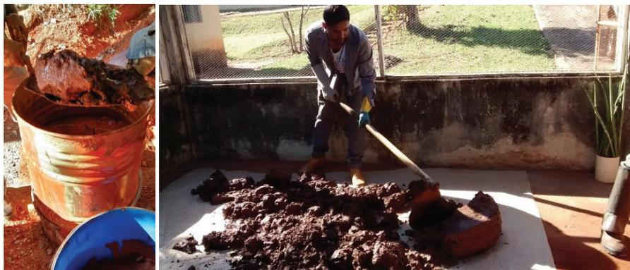
**Figura 2.** Preparo do rejeito de minério de ferro para secagem para posterior utilização em vasos experimentais. Sete Lagoas, 2016.
