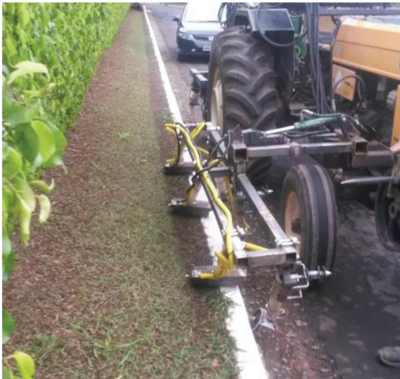
Figura 9. Uso da eletrocussão no controle de plantas daninhas em áreas urbanas. Fotos : Efeito imediato do primeiro equipamento de Capina Elétrica – Concessão Zasso Brasil Indústria e Comércio Ltda
