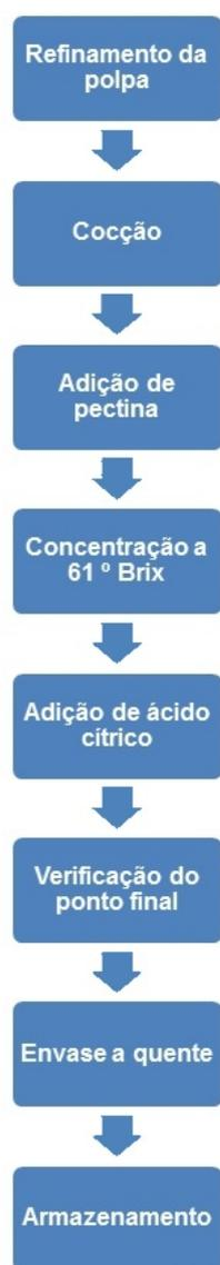
**Figura 5.** Fluxograma para obtenção de geleia de abacaxi.
