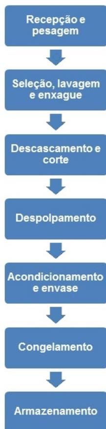
**Figura 1.** Fluxograma para obtenção de polpa de abacaxi congelada.
