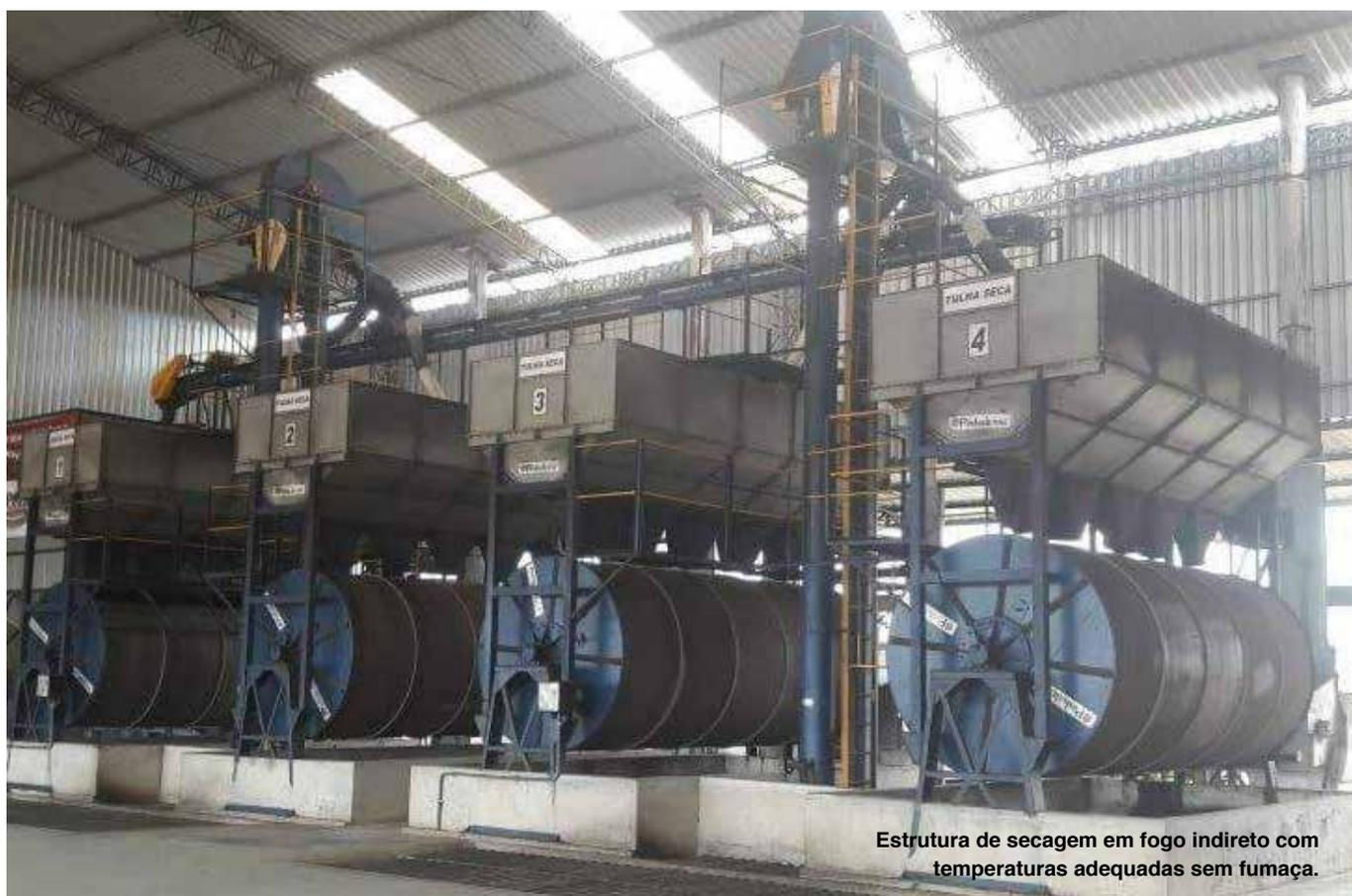
Estrutura de secagem em fogo indireto com temperaturas adequadas sem fumaça.
