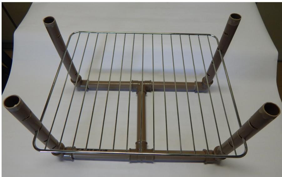
**Figura 8.** Detalhe do encaixe da bandeja no entalhe do tubo.
