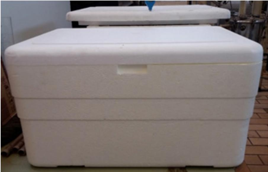
**Figura 1.** Caixa de isopor com capacidade para 80 litros onde será instalado, em seu interior, os sistemas de aquecimento e ventilação e a estrutura tubular com as bandejas.
