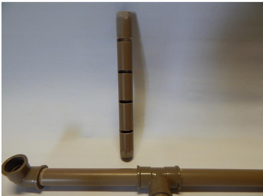
**Figura 7.** Detalhe da fenda feita com uma lima para o encaixe das bandejas.
