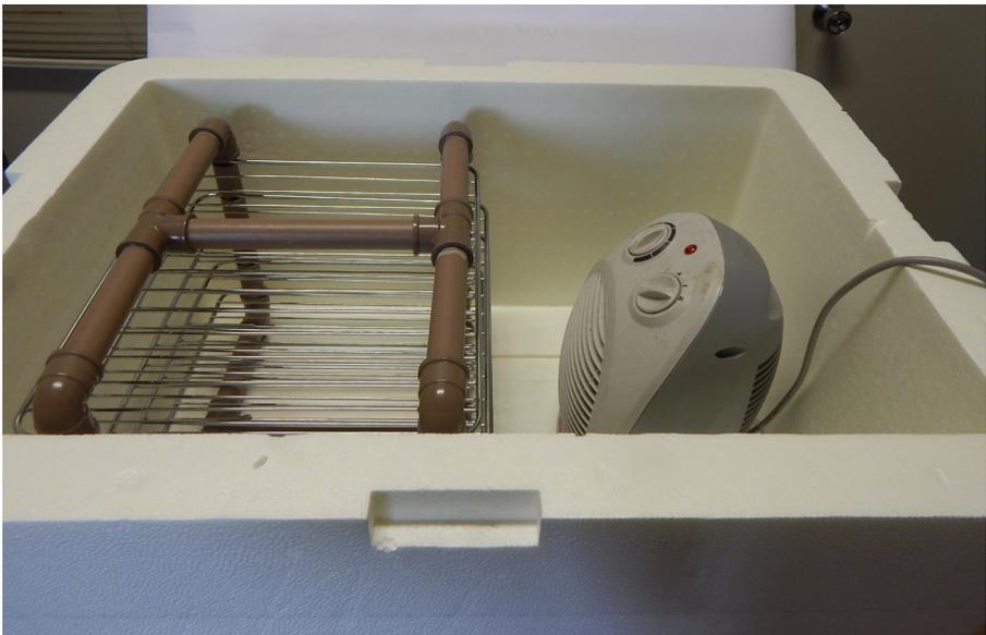
**Figura 2.** Caixa de isopor com o sistema de aquecimento e ventilação e módulo com as bandejas.
