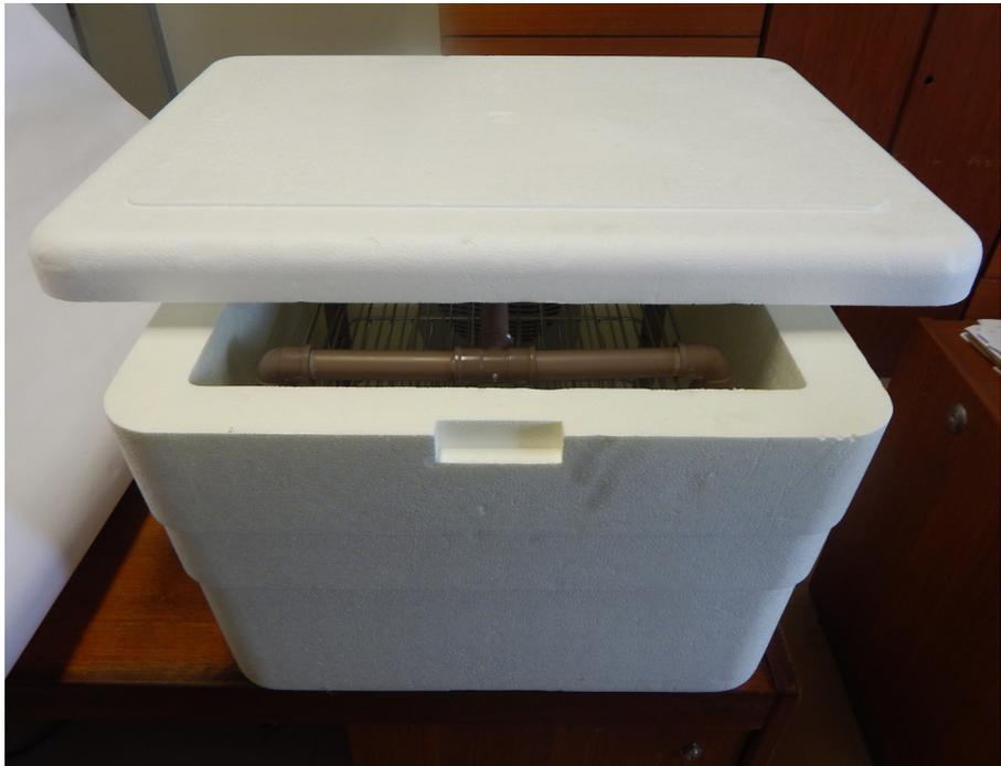
**Figura 13.** Detalhe da tampa da caixa de isopor colocada transversalmente para se manter aberta para entrada e saída do ar de secagem.
