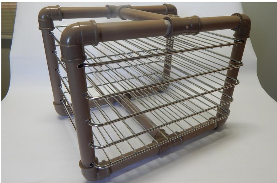
**Figura 3.** Módulo construído em tubos de PVC com 25 mm de diâmetro e bandejas de aço inoxidável.
