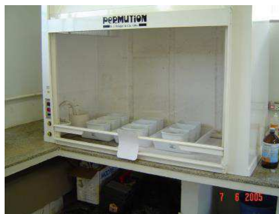
Figura 4. Capela de exaustão de ar forçado com amostras em processo de polimerização. Foto: Miguel Cooper.
