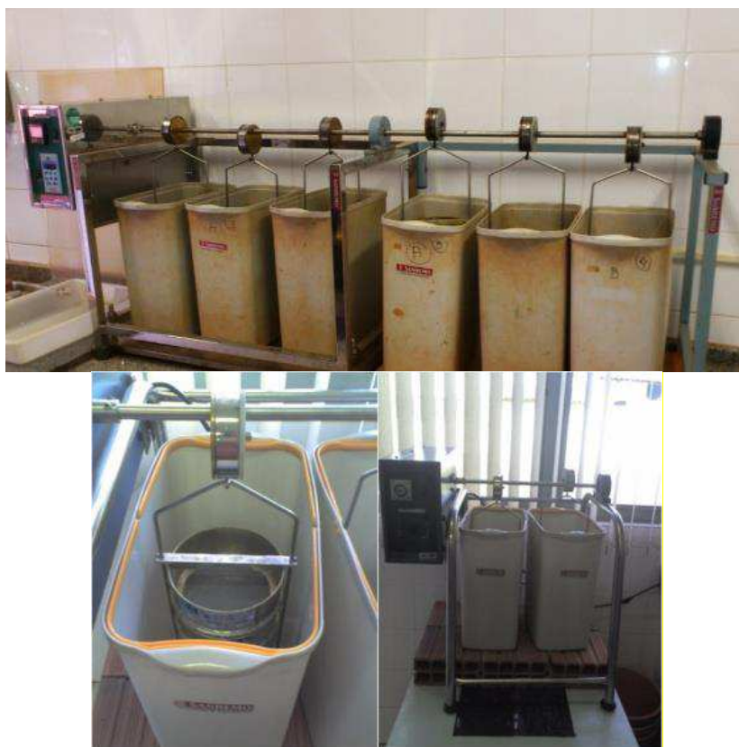
Figura 2. Detalhes do equipamento utilizado para realizar o peneiramento em água. Fotos: Júlio Cesar Salton.
