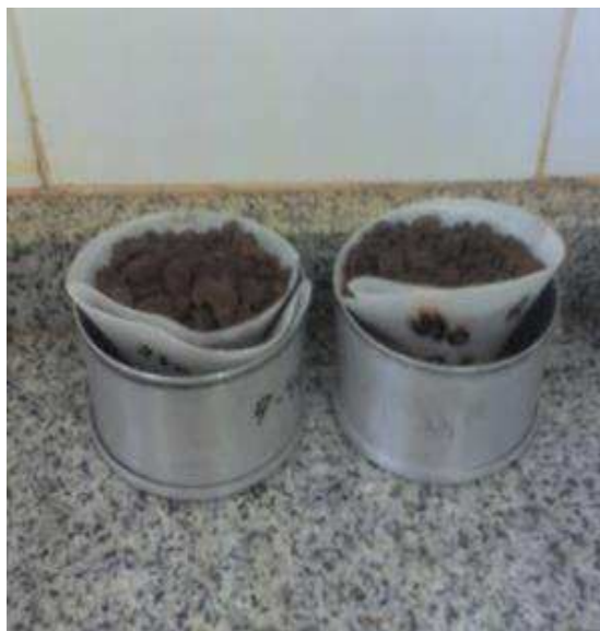
Figura 3. Detalhe do umedecimento das subamostras por capilaridade. Foto: Júlio Cesar Salton.
