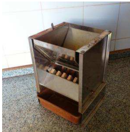
Figura 1. Quarteador tipo Jones utilizado para obtenção de subamostras homogêneas do solo. Foto: Júlio Cesar Salton.
