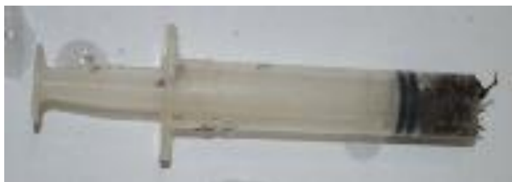
Figura 1. Seringa com a parte de cima removida para medir volume do material orgânico. Foto: Paula Fernanda Soares.
