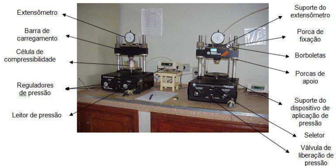
Figura 1. Unidade de consolidação. Consolidômetro S-450 Terraload. (Durham Geo Enterprises, USA). Foto: Diego Tassinari.
