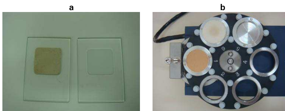
Figura 3. Recipientes para montagem não orientada (amostras em pó): (a) lâminas de vidro com cavidade rasa e (b) recipientes de alumínio em porta-amostras. Fotos: Gilson Gregoris.
