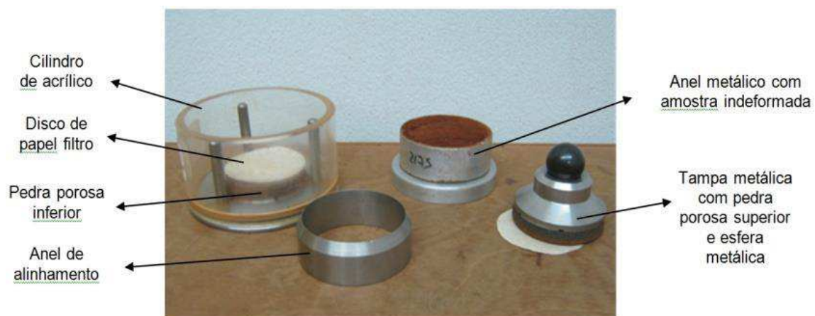
Figura 2. Célula de compressibilidade com acessórios. Foto: Diego Tassinari.
