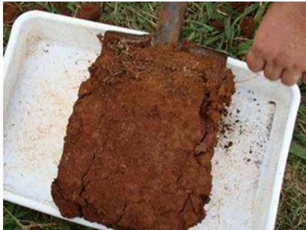
Figura 3. Disposição correta da amostra na bandeja plástica. Foto: Adoildo da Silva Melo.
