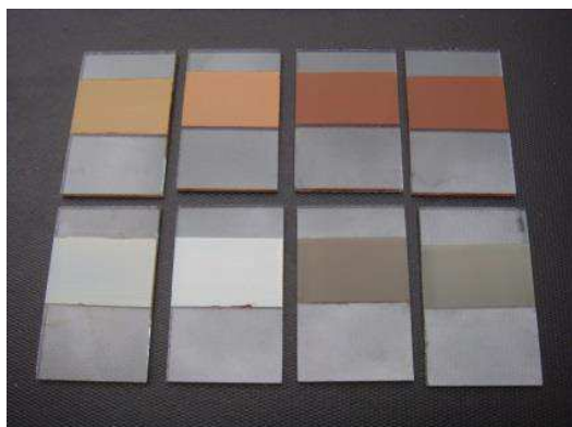
Figura 4. Alteração da cor de amostras de argila após a desferrificação: amostras não tratadas (superiores) e desferrificadas (inferiores). Foto: Gilson Gregoris.
