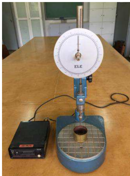
Figura 3. Aparelho denominado Cone de Penetração para determinação do limite de liquidez do solo. Foto: Igor Rodrigues de Assis.
