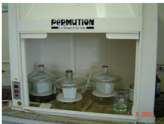
Figura 3. Sistema de impregnação utilizando dessecadores e vácuo. Foto: Miguel Cooper.
