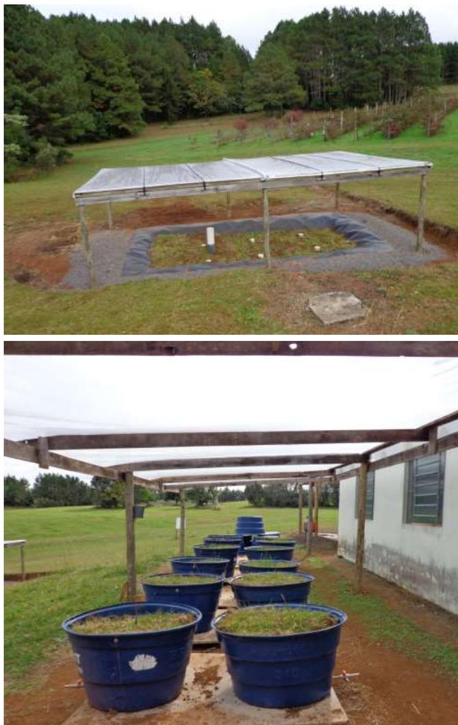
Fig. 5. Exemplos de cobertura de biobed com filme plástico de estufa.
