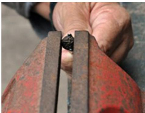
**Figura 5.** Posicionamento do pirênio de murucizeiro na morsa.
