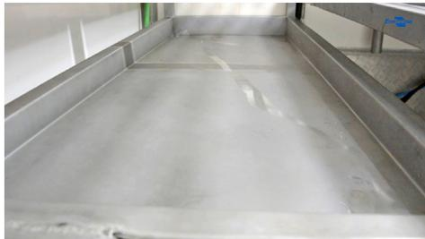
**Figura 7.** Calha coletora de sangue.
