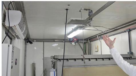
**Figura 13.** Talha elétrica, balancim e trilhamento.
