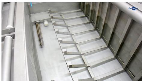
**Figura 9.** Tanque de escaldagem.
