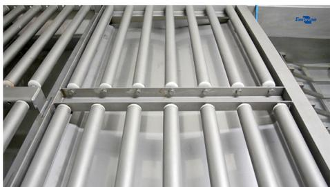
**Figura 8.** Calha coletora de água.
