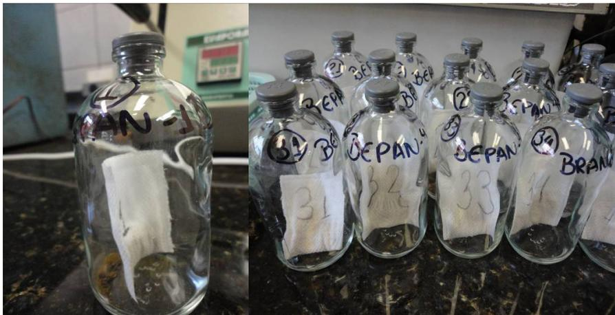
Figura 2. Garrafas de vidro identificadas contendo em seu interior as bolsas de filtro de TNT previamente numeradas.
