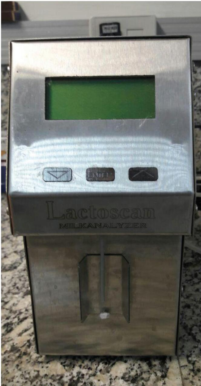
Figura 1. Analisador de leite Ultrassônico-Lactoscan.
