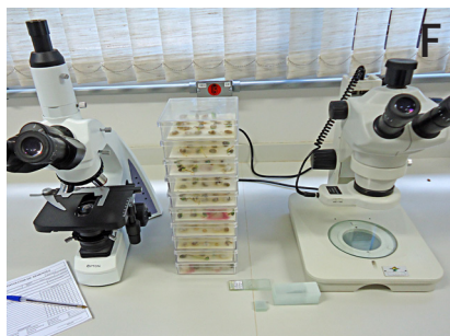
Figura 1. Ensamblaje de la prueba del papel secante. A) Materiales a utilizar; B) cajas tipo gerbox para desinfección con NaOCl al 1,05%; C) agua destilada en autoclave para humedecer el papel de filtro estéril; D) veinte semillas por gerbox; E) muestras en la cámara de incubación a 20 \pm 2 ° C durante 7 días; F) evaluación de patógenos y saprófitos.
