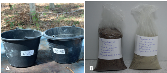
Figura 11. Baldes com a identificação das profundidades para a coleta de solo (A) e sacos plásticos identificados contendo amostras de solo (B).
