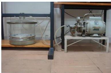
**Figura 5.** Sistema para solvatação com etilenoglicol a frio, composto por um dessecador e uma bomba de vácuo.
