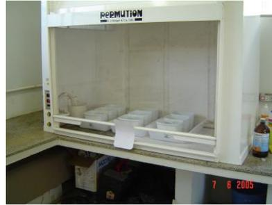
**Figura 4.** Capela de exaustão de ar forçada com amostras em processo de polimerização. Foto: Miguel Cooper.
