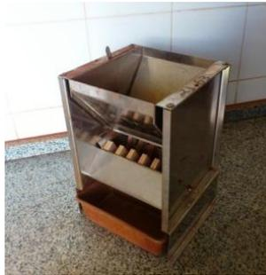
**Figura 1.** Quarteador tipo Jones utilizado para obtenção de subamostras homogêneas do solo. Foto: Júlio Cesar Salton.
