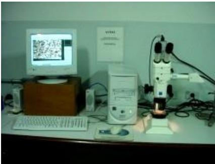
**Figura 11.** Sistema de análise de imagens com câmera fotográfica digital acoplada a uma lupa binocular. Foto: Miguel Cooper.
