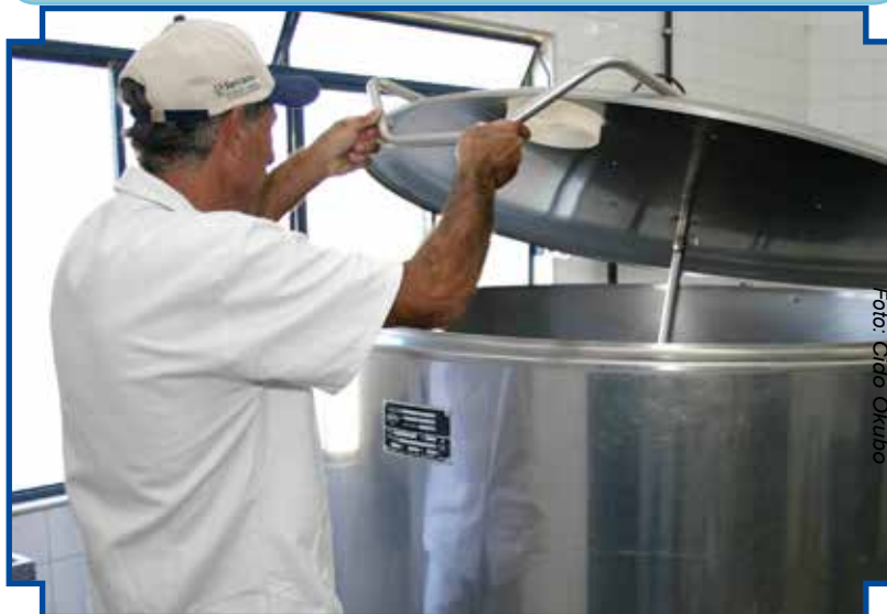
Tanque de refrigeração
