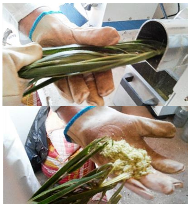
Figura 5. Processo de extração de fibra da bocaiuva
