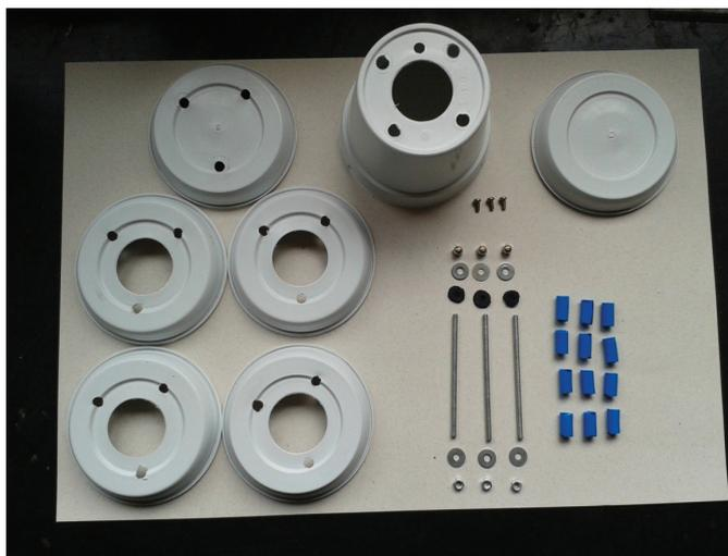
**Figura 1.** Peças usadas na confecção do protetor de radiação solar para uso com termo-higrógrafos digitais eletrônicos.
