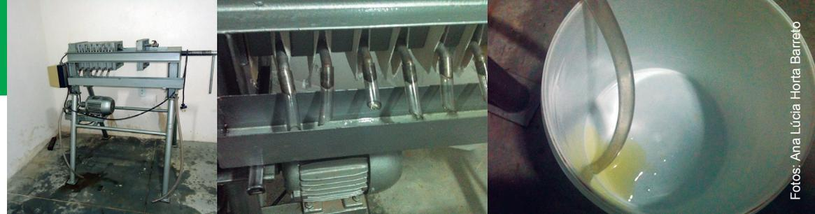
O sistema de extração de óleos pode ser utilizado em pequena escala sem o uso de solventes, por meio de uma prensa contínua de pequeno porte com capacidade de processamento de 40 kg/h de matéria-prima. Óleos obtidos por extração mecânica a partir de sementes de boa qualidade são indicados para utilização na alimentação humana. Por não conterem aditivos químicos, nem sofrerem o refino químico, são considerados produtos naturais e são bastante valorizados no mercado de produtos naturais.
