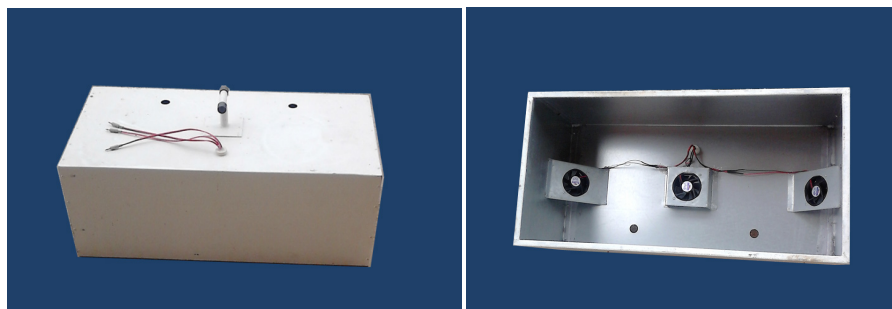
Figura 9. Vistas de topo de câmara estática em aço galvanizado, com acabamento em pintura de cor branca, ilustrando, externamente, alça para o manuseio da câmara, fiação que liga os ventiladores internos à bateria e orifícios para o acoplamento de termômetro digital tipo espeto e dispositivo para tomada de amostras de ar (a), e internamente ventiladores para homogeneização do ar no interior da câmara, instalados em suportes específicos (b).
