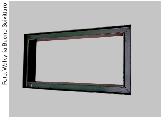
Figura 7. Vista superior de base de câmara estática fechada em aço galvanizado com pintura em cor verde, ilustrando canaleta superior onde é feito o acoplamento da base ao topo.
