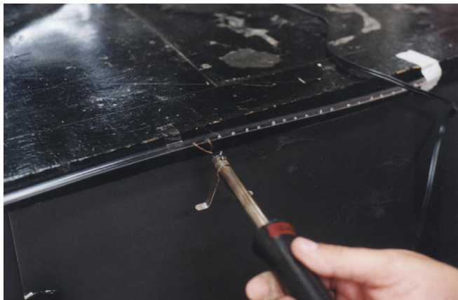
Figura 13. Confecção de furos em um dos lados do tubo de polietileno com o auxílio de um ferro de soldar adaptado com um fio de cobre bifurcado, em substituição à ponta tradicional.
