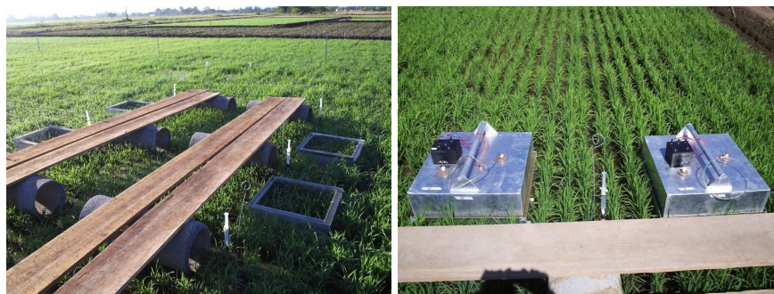
Figura 10. Estruturas constituídas por tubos de cimento e tábuas de madeira para o suporte e movimentação do amostrador durante os procedimentos de coleta de amostras em sistemas alagados.
