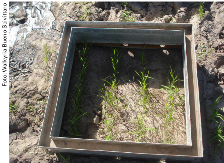
Figura 2. Base de câmara estática fechada em alumínio, instalada em lavoura de arroz antecedendo a inundação do solo, ilustrando os orifícios para circulação de água entre o ambiente externo e o sistema coletor e a canaleta superior onde é feito o acoplamento da base ao topo e/ou extensor.
