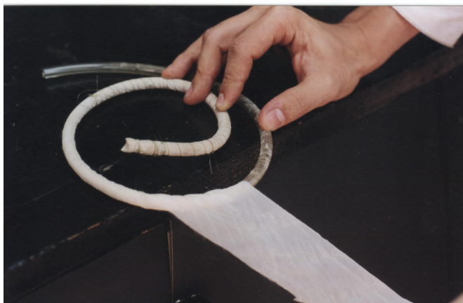
Figura 14. Recobrimento do tubo de polietileno com tela de “nylon” e fixação com linha de “nylon”.
