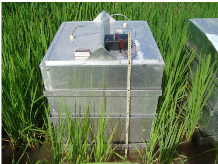
Figura 4. Câmara estática fechada em alumínio composta por base, dois extensores e topo em lavoura de arroz irrigado durante amostragem.
