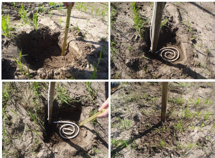
Figura 16. Procedimentos de instalação de dispositivo de coleta da solução do solo em lavoura de arroz irrigado em sistema de semeadura em solo seco, incluindo a abertura de buraco na profundidade de 10 cm (a), colocação do dispositivo de coleta (b); conferência da profundidade (c); e posterior cobertura com solo (d).
