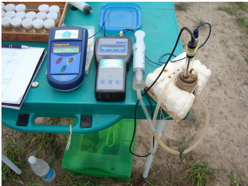
Figura 18. Procedimento de medida do potencial redox (Eh) e do pH com a solução do solo no interior da câmara eletrométrica.
