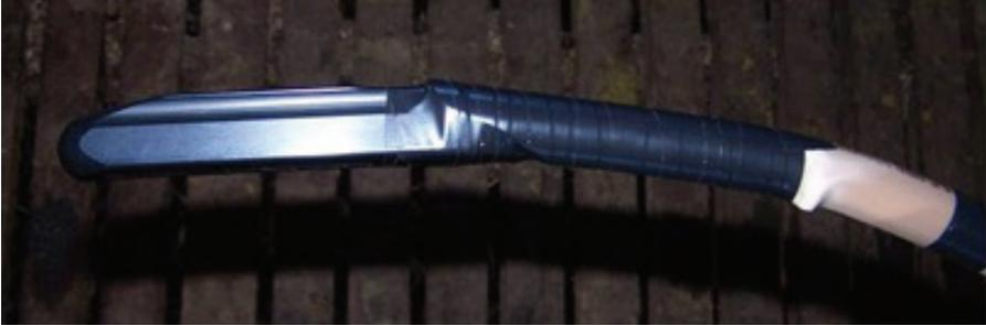
**Figura 3.** Transdutor linear acoplado a um cano de PVC dobrado para realizar avaliações pela via transretal em ovinos. Para acoplar o transdutor ao bastão pode ser utilizada fita isolante de autofusão (emborrachada). É importante que não fiquem bordas cortantes nem proeminências que possam agredir o reto do animal.
