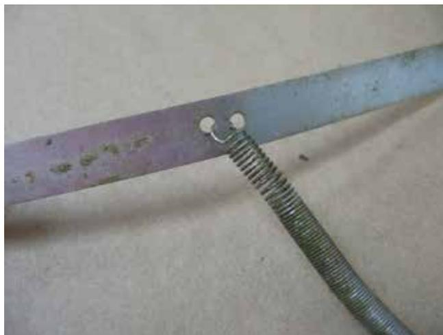
**Figura 6.** Detalhe de como colocar a mola antes de instalar a cinta.
