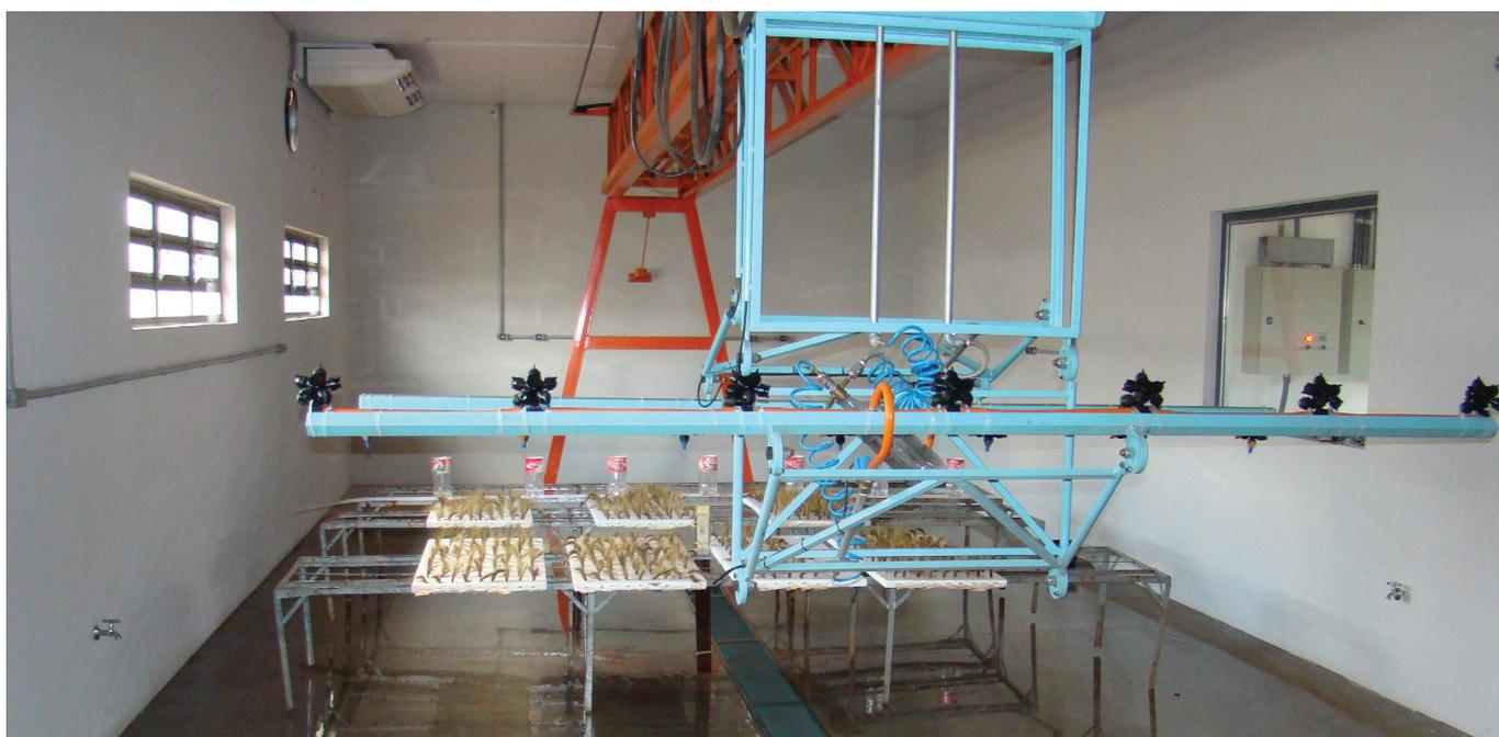
**Figura 6.** Simulador de chuva para avaliação da porcentagem (%) de grãos germinados em espigas colhidas previamente no campo, sendo embebidas com água durante 60 horas a uma temperatura entre 25°C e 30°C.
