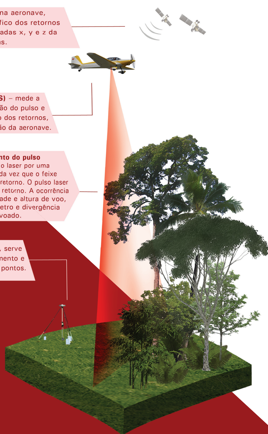
Figura 1. Funcionamento e equipamentos usados no escaneamento a laser aerotransportado – ALS ( Aerial Laser Scanning ).
