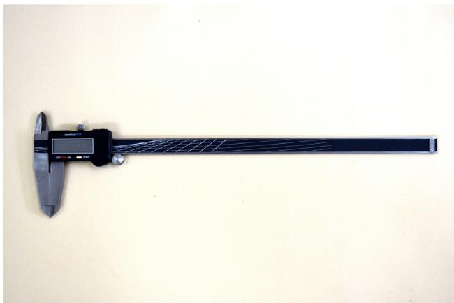
**Figura 7.** Paquímetro digital utilizado para medir pequenos e médios quelônios.
