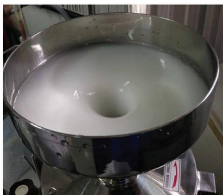
Figura 5. Suspensão de celulose branqueada sendo alimentada no moinho para desfibrilação das fibras.
