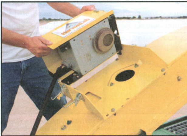
Figura 2 – Equipamento HarvestLab (John Deere, IL, EUA): exemplo de sistema constituído de espectrômetro NIR baseado em rede de difração fixa como elemento dispersivo. O dispositivo pode ser montado diretamente sobre máquinas agrícolas, permitindo o monitoramento de parâmetros de qualidade de diferentes culturas diretamente no campo (fonte: http://www.deere.com ).
