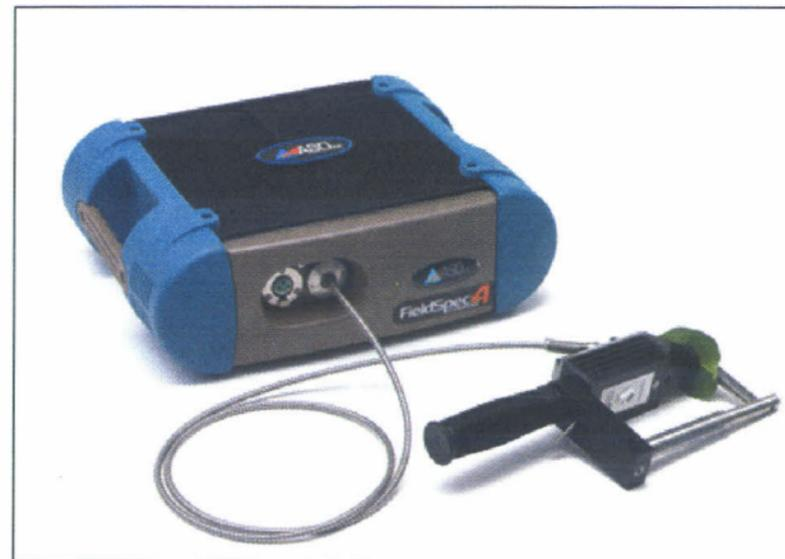
Espectrorradiômetro, sensor de campo e laboratório utilizado para avaliar o comportamento espectral da vegetação, solo e água. Ajuda a caracterizar cultivares e inferir doenças da planta. É um equipamento de alta resolução e seus dados podem ser correlacionados com dados de satélites.
