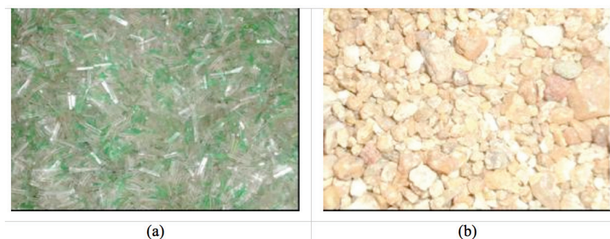
Figura 1 - Ilustração dos resíduos de garrafas de PET triturados (a) peneiramento de areia lavada (b) utilizados na confecção dos corpos de prova para ensaios de compressão.
