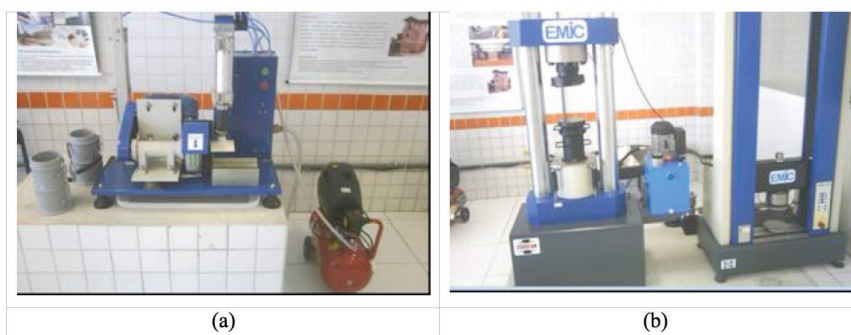
Figura 2. Ilustração dos equipamentos utilizados na retificação dos corpos de prova (a) e nos ensaios de avaliação da resistência à compressão (b) do Laboratório de Engenharia da UnP em Mossoró-RN.
