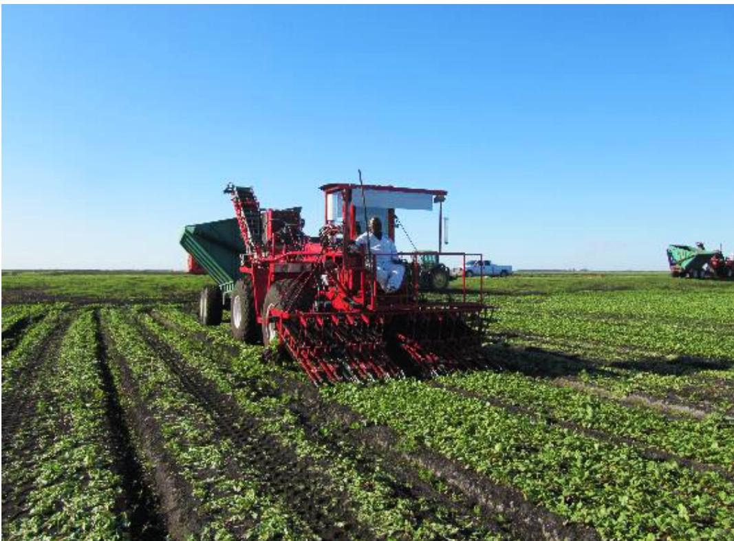
**Figura 7-** Colheita mecânica de rabanete. Obs: a máquina separa a raiz da planta.
