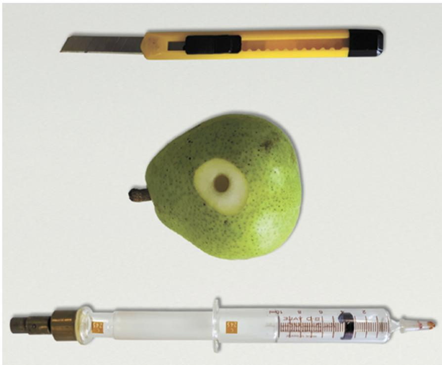
**Figura 2.** Penetrômetro a gás com ponteira cilíndrica de 8 mm, contendo um anel plástico interno de marcação do volume comprimido final.
