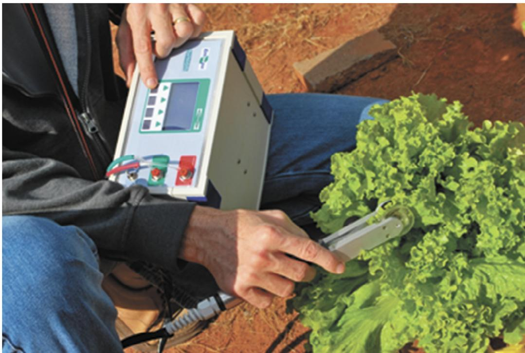
**Figura 12.** Instrumento Wiltmeter® para medir a pressão de turgescência celular de folhas.
