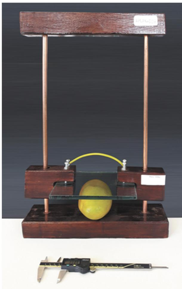
**Figura 10.** Aplanador com placa transparente pesando cerca de 1,0 kgf com o qual se estima a pressão de turgescência celular dos tecidos de frutas e hortaliças (CALBO; NERY, 1995a).
