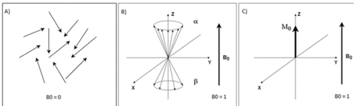
**Figura 1A, 1B, 1C.** Representação dos spins fora do campo magnético  $B_0$  (A), cone de precessão (B) e do vetor magnetização resultante ( $M_0$ ) no estado de equilíbrio térmico (C).
