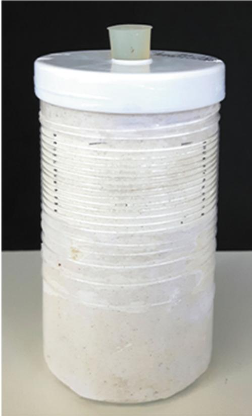
**Figura 14.** Atmômetro de pós-colheita para medir poder evaporativo do ar (evaporatividade) em *mm/dia*.
