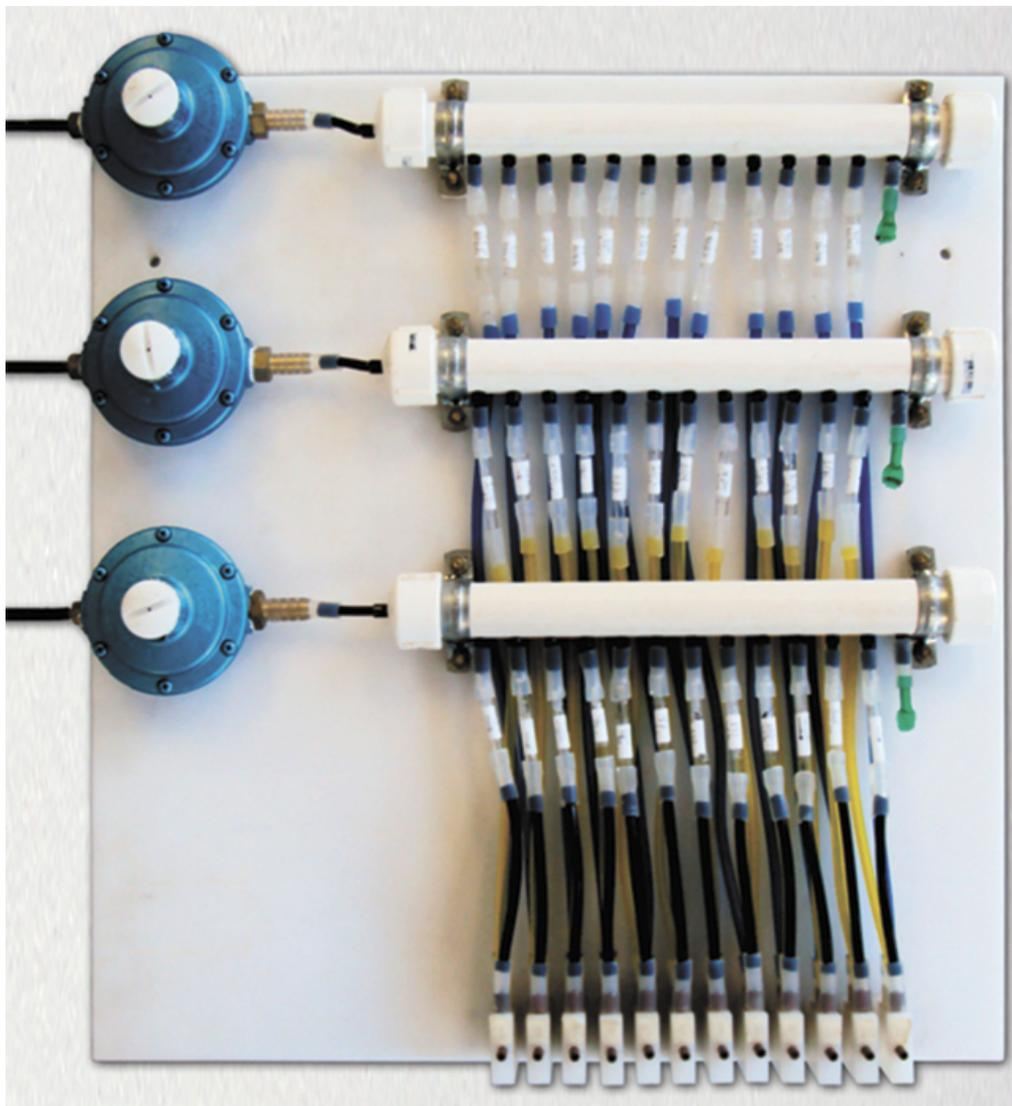
**Figura 8.** Fluxcentro portátil ligado a câmaras de trocas gasosas durante um estudo de atmosfera controlada aplicada a frutos de tomate.
