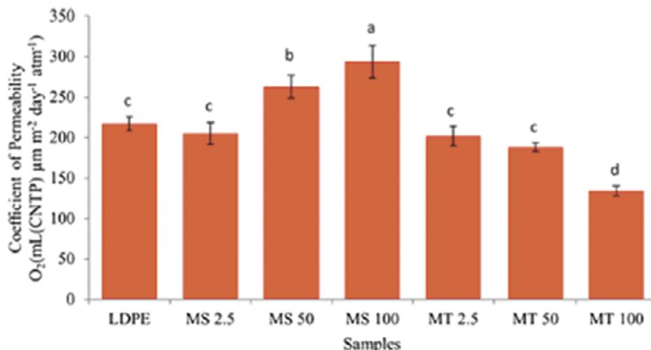
**Figura 7.** Resultados dos testes de permeabilidade para os filmes compósitos de PEBD aditivados com carreadores inorgânicos (óxido de silício – MS, e óxido de titânio – MT) e prata: média do coeficiente de permeabilidade a  $O_2$  e valores de desvio padrão. Valores representados pela mesma letra não são significativamente distintos a um nível de 5%, de acordo com o teste de Duncan.
