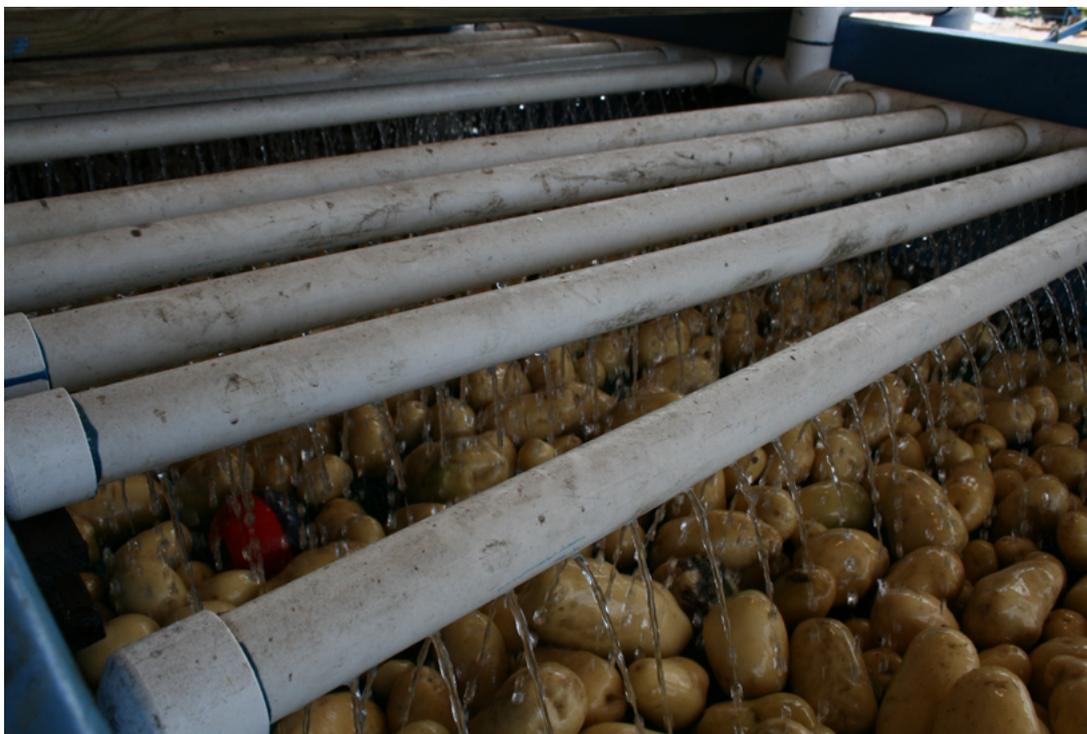
**Figura 15.** Lavagem e enxágue de batatas na linha equipada com escovas giratórias em etapa anterior à secagem.
