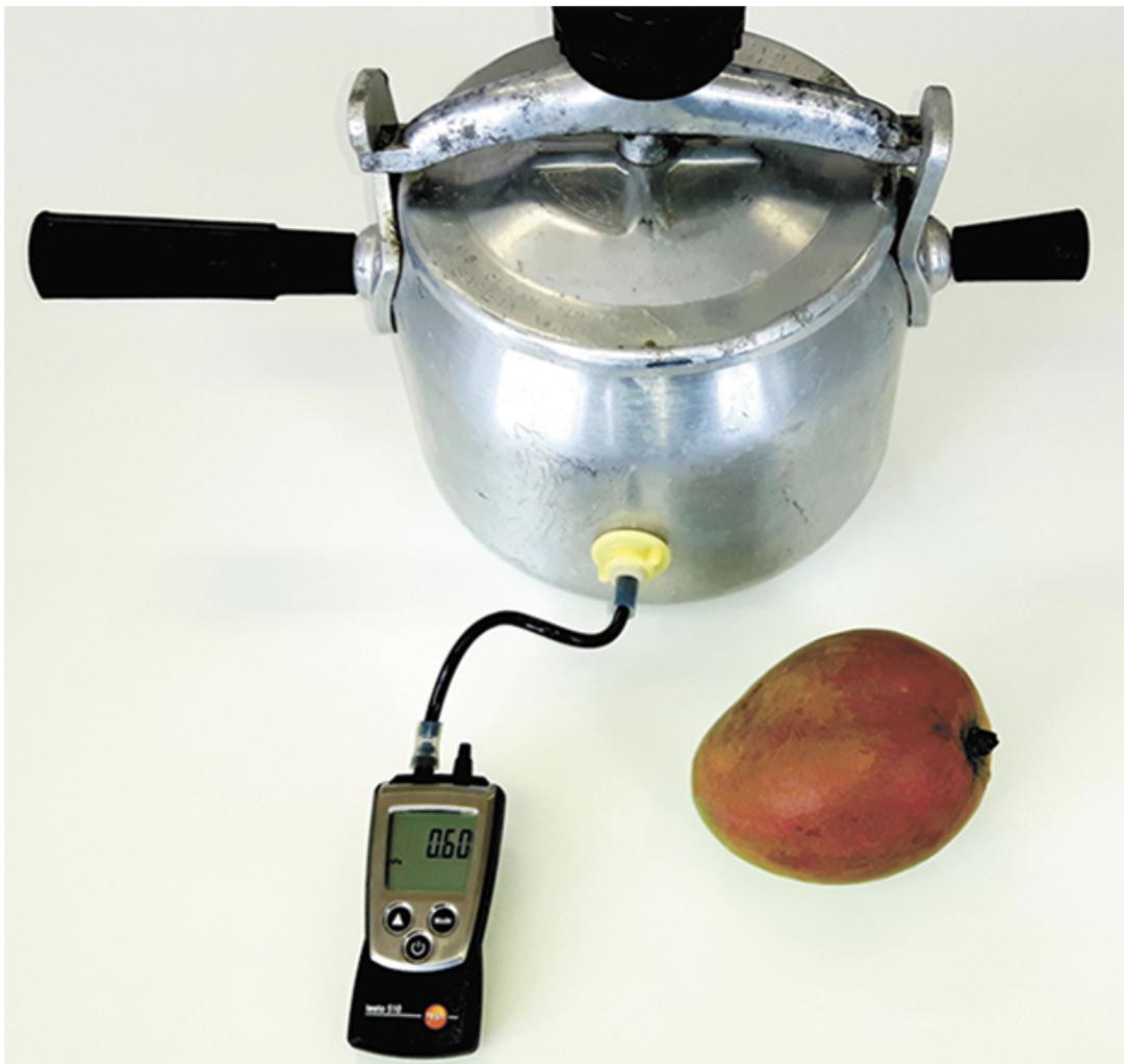
**Figura 13.** Câmara de transpiração hermeticamente acoplada a um transdutor de pressão MPX2010, com escala de leitura entre 0 e 10 *kPa* e sensibilidade de 2,5 *mV/kPa*, ao ser alimentado por uma fonte de 10 Volts de corrente contínua.
