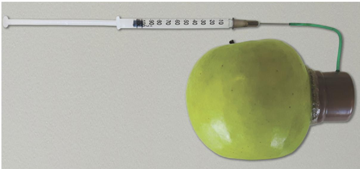
**Figura 3.** Câmara Externa de Devaux, preparada com um cap para tubo de PVC de 25 mm acoplado à superfície de um fruto de maçã. Também estão ilustrados a cola de poliuretano utilizada para vedar externamente a câmara ao fruto e um sistema de coleta de amostras gasosas com auxílio de um microtubo e uma seringa de 1,0 mL. Foto: Luis Gustavo Paulino Carmelo.
