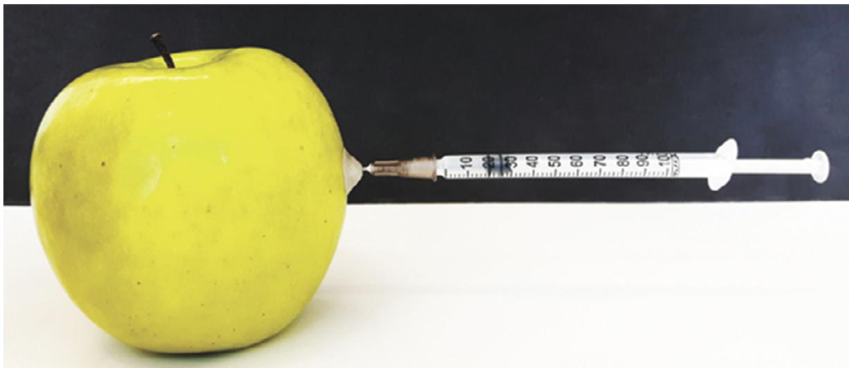
**Figura 5.** Amostra gasosa sendo removida de um fruto de maçã com uma seringa. Nota-se uma camada de massa de calafetar, afixada sobre o fruto, para evitar a entrada de ar através do orifício produzido pela agulha de coleta. Foto: Luis Gustavo Paulino Carmelo.
