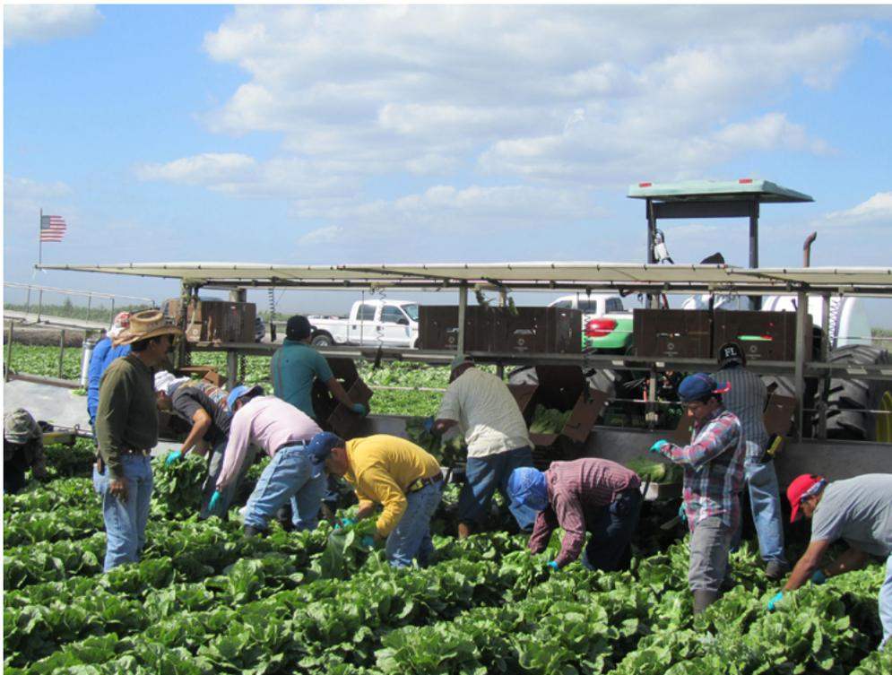
**Figura 3.** Plataforma de colheita com tração motorizada.
