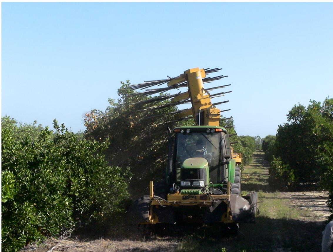
**Figura 6.** Máquina utilizada para colheita de laranjas utilizando varas/varões para retirada dos frutos.
