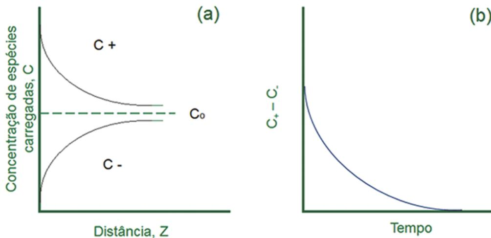
**Figura 4.** A concentração de cargas e, por conseguinte, a de material depositado tende a zero com a distância (a) e com o tempo de imersão (b).
