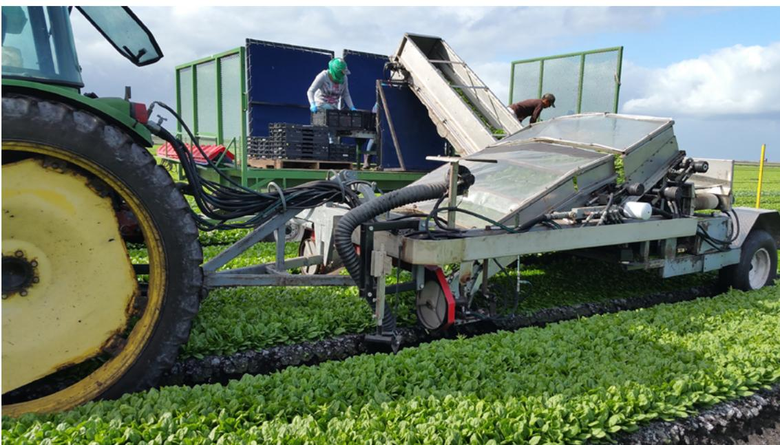
**Figura 8-** Colheita de espinafre em estágio inicial – baby spinach. Vista lateral do equipamento de colheita.
