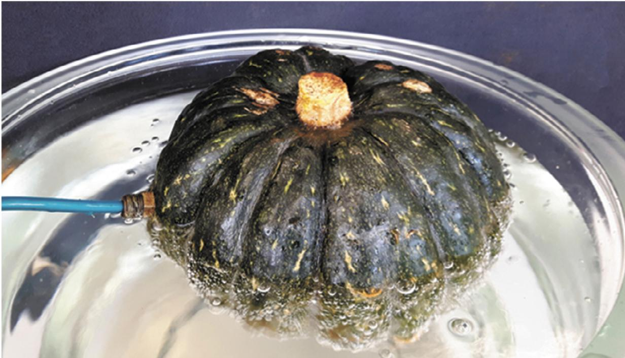
**Figura 1.** Borbulhamento de ar através de uma moranga imersa em água. Neste ensaio o ar sob pressão, conduzido por um tubo flexível, é insuflado através de um espigão metálico, firmemente fixado a um orifício efetuado no fruto.
