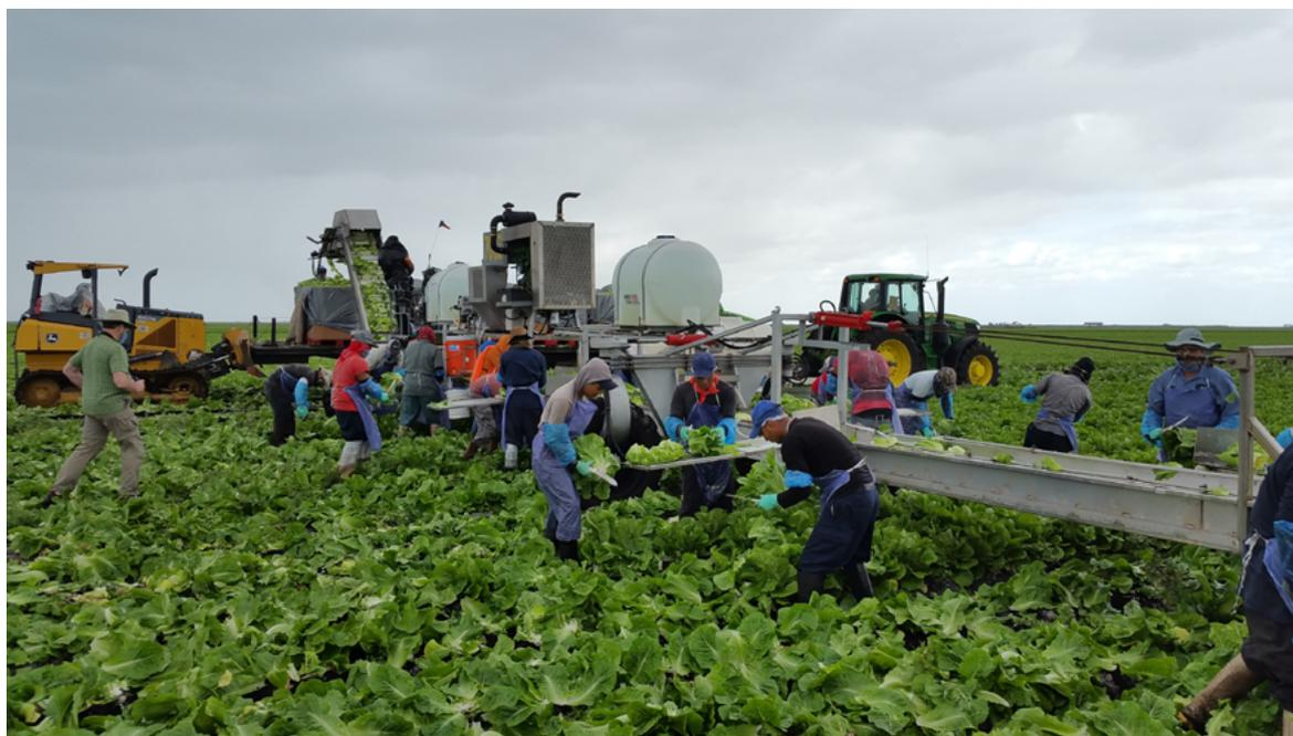
**Figura 4.** Plataforma de colheita para folhosas, com indicação de distintas esteiras de beneficiamento em campo.
