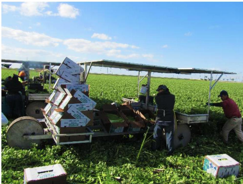
**Figura 2.** Plataforma de colheita movimentada manualmente em colheita de folhosas.
