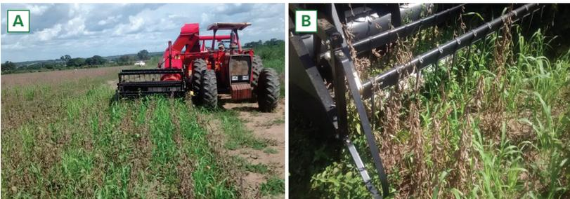
**Figura 7.** Operação mecanizada de colheita de soja em área sobressemeada com *P. americanum* (milheto). Detalhe da área antes e após a passagem da colhedora (A) e do sistema de colheita (B). Gurupi/TO, safra 2013/14.
