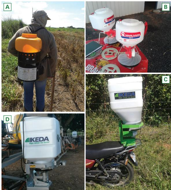
**Figura 3.** Equipamentos para operação de sobressemeadura de capins na soja: distribuidores de sementes e fertilizantes costais (A e B), implementos agrícolas acoplados em motocicletas (C), ou acoplados em barras dos pulverizadores tratorizados para aplicação simultânea de semente e defensivo (D). FOTOS: Emerson Borghi.
