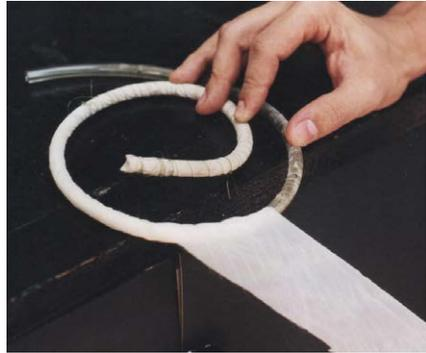
**Fig. 20.** Recobrimento do tubo de polietileno com tela de nylon e fixação com linha de nylon.
