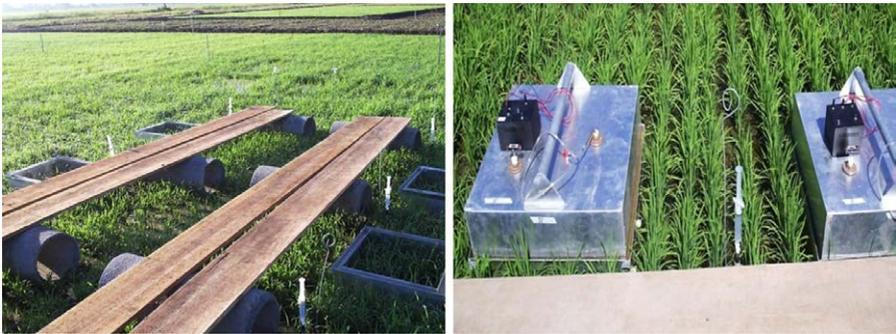
**Fig. 16.** Estruturas constituídas por tubos de cimento e tábuas de madeira para o suporte e movimentação do amostrador durante os procedimentos de coleta de amostras em sistemas alagados.
