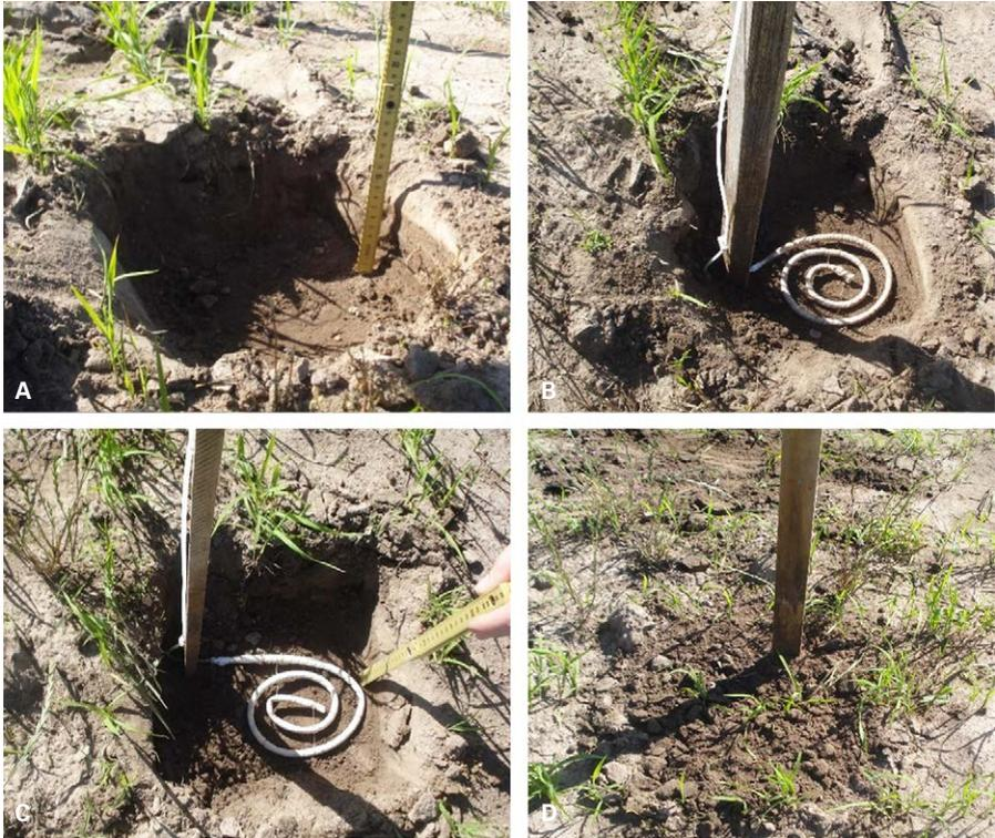
**Fig. 22.** Procedimentos de instalação de dispositivo de coleta da solução do solo em lavoura de arroz irrigado em sistema de semeadura em solo seco, incluindo a abertura de buraco na profundidade de 10 cm (A), colocação do dispositivo de coleta (B); conferência da profundidade (C) e posterior cobertura com solo (D).
