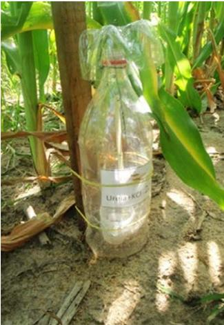
**Fig. 27.** Câmara feita de garrafa PET posicionada em local fertilizado com N, escorada por uma estaca de madeira com o auxílio de elásticos de borracha.
