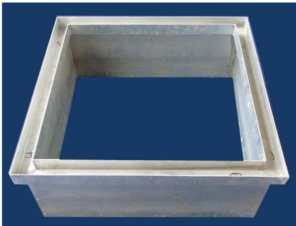
**Fig. 8.** Extensor de câmara estática fechada em alumínio com canaleta superior para o acoplamento de topo ou de outro extensor, distinguindo-se da base pela ausência de orifícios laterais.
