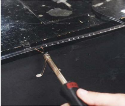
**Fig. 19.** Confeção de furos em um dos lados do tubo de polietileno com o auxílio de um ferro de soldar adaptado com um fio de cobre bifurcado, em substituição à ponta tradicional.
