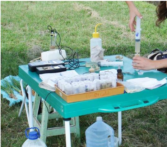
**Fig. 25.** Filtragem da solução do solo em filtro 0,45  $\mu\text{m}$  e transferência para os frascos de transporte e estocagem.
