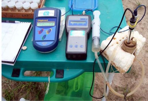
**Fig. 24.** Equipamentos de medida do potencial redox (Eh) e do pH com a solução do solo no interior da câmara eletrométrica.
