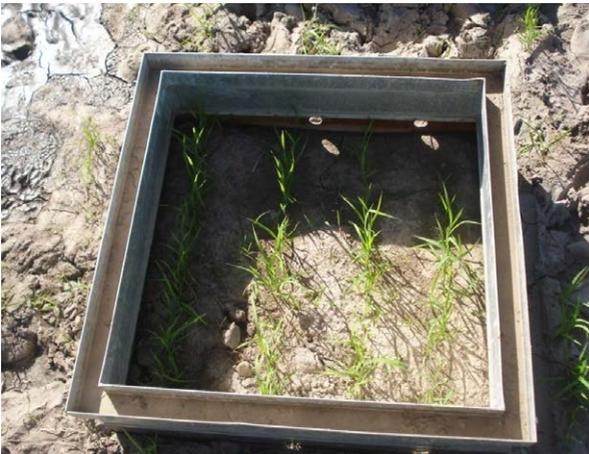
**Fig. 7.** Base de câmara estática fechada em alumínio, instalada em lavoura de arroz antecedendo a inundação do solo, ilustrando os orifícios para circulação de água entre o ambiente externo e o sistema coletor e a canaleta superior onde é feito o acoplamento da base ao topo e/ou extensor.
