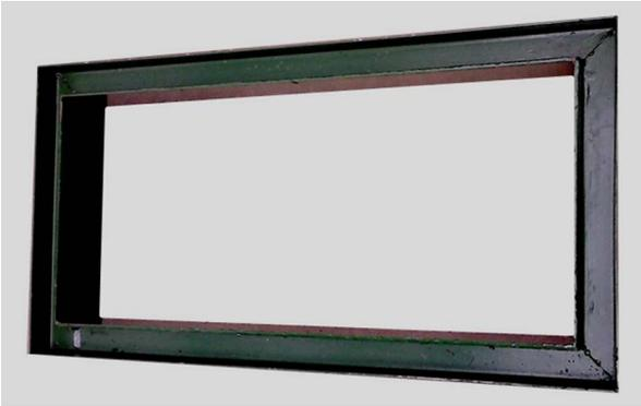
**Fig. 11.** Vista superior de base de câmara estática fechada em aço galvanizado com pintura em cor verde, ilustrando canaleta superior onde é feito o acoplamento da base ao topo.
