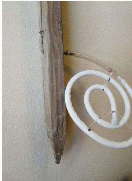
**Fig. 21.** Dispositivo de coleta de solução do solo fixado em estaca de madeira.
