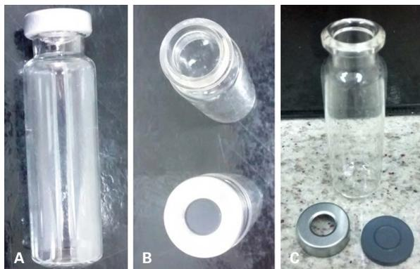
**Fig. 15.** (A) Frasco cromatográfico. (B) Frasco sem septo e sem lacre (acima) e frasco com septo de borracha e lacre (abaixo). (C) Detalhe do lacre (esquerda) e do septo de borracha (direita).
