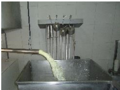
Figura 6. Massa com soro sendo transportados para tanque de 500 L.
