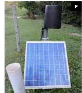
Medições por sensores: estação meteorológica (A); imagem do satélite Landsat (B); pluviômetro para medir a precipitação (C); vertedouro para permitir medir a vazão do rio (D); datalogger com bateria alimentada por meio de placa solar, ligado a sensores de parâmetros diversos que compõe estação automática (E e F).
