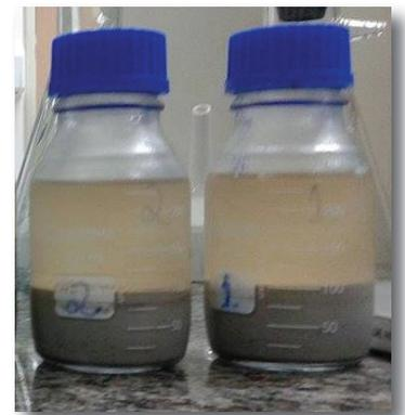
**Figura 2.** Resíduo sólido e solução de açúcares da hidrólise enzimática de lodo de papel.
