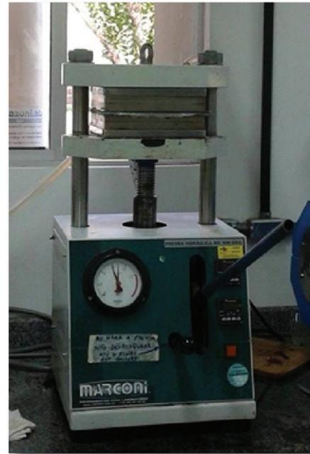
Figura 4. Prensa hidráulica.
