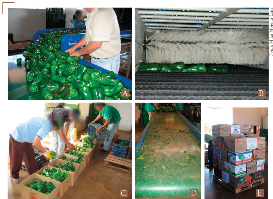
Figura 13. Práticas durante o beneficiamento de pimentão que acarretam danos físicos ao fruto: (A) desregulação dos equipamentos de limpeza e classificação; (B) uso de escovas muito duras; (C) virada dos frutos de uma caixa para outra seguida da batida das caixas para acomodar os frutos; (D) bancadas sujas; (E) empilhamento de caixas não padronizadas.
