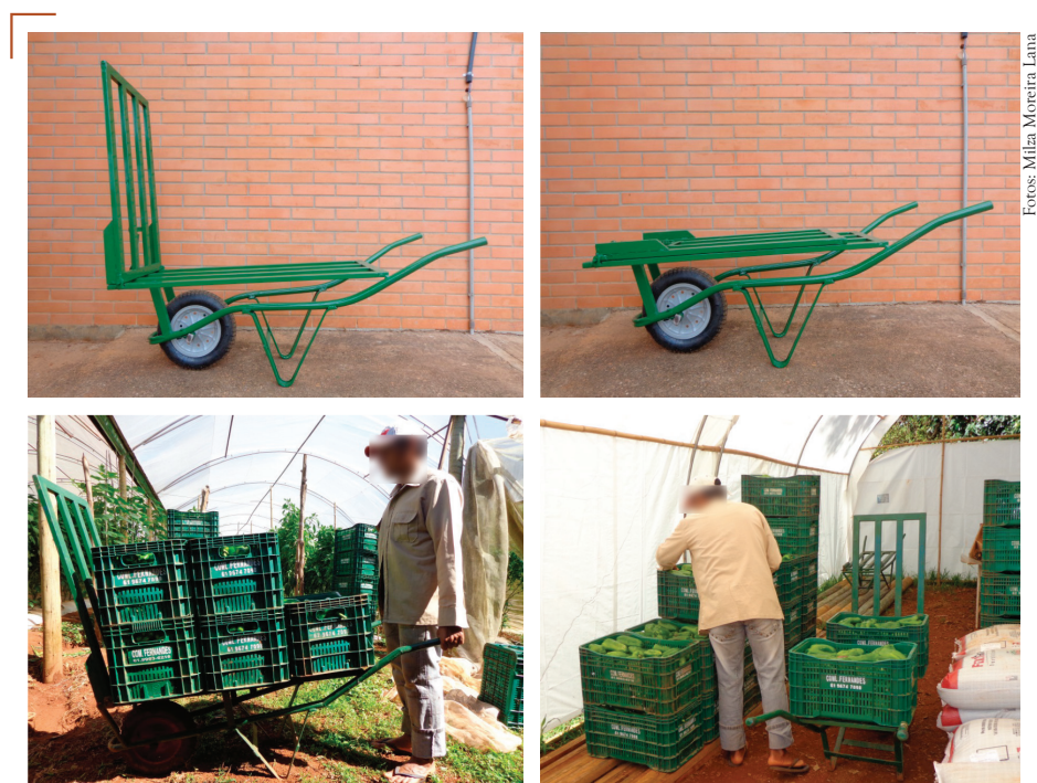
Figura 17. Modelo de carrinho para colheita e transporte de hortaliças proposto pela Embrapa Hortaliças. O encosto do carrinho é dobrável facilitando seu transporte para diferentes locais da propriedade ou seu transporte junto à carga de hortaliças para uso no mercado. O carrinho pode ser usado durante a colheita e/ou para o transporte da hortaliça do campo para a casa de embalagem.
