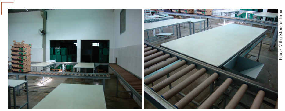
Figura 24. Esteira de roletes para movimentação de cargas na casa de embalagem; vista geral e detalhe da esteira acoplada à mesa de seleção.
