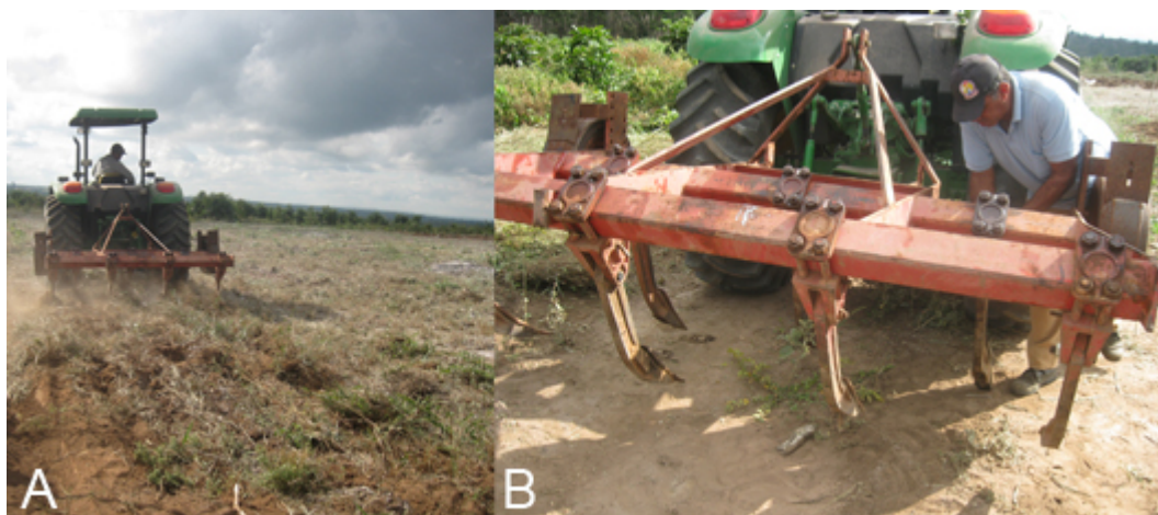
Figura 1. Preparo da área com o escarificador para o plantio (A); detalhe do escarificador (B).
