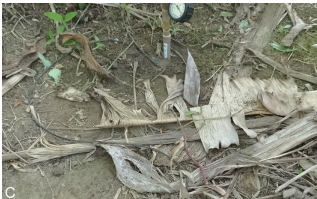
Figura 1. Sensores de umidade ou de tensão de água do solo: Indicador de umidade do solo (A), Irrigas (B) e Tensiômetro (C).
