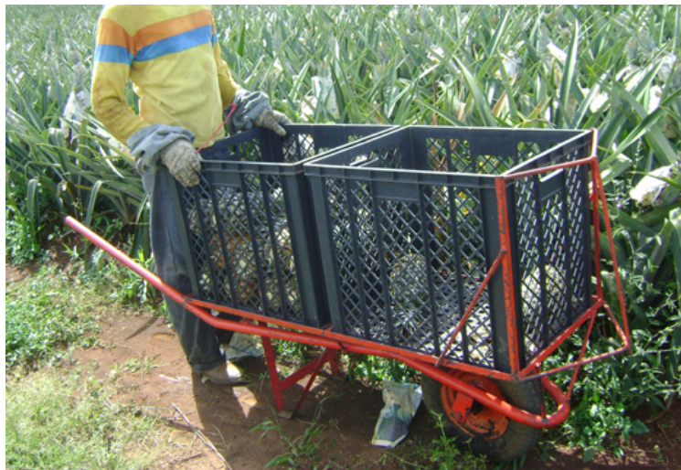
Figura 1. Carro de mão adaptado com caixas plásticas para colheita de abacaxi
