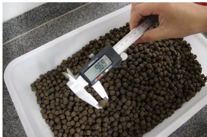
**Figura 4.** Medição da granulometria de pélete de ração com auxílio de paquímetro. Foto: Luiz Eduardo Lima de Freitas.
