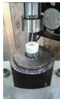
**Figura 4.** *Pellet* produzido em Briquetadeira Lippel LB32.
