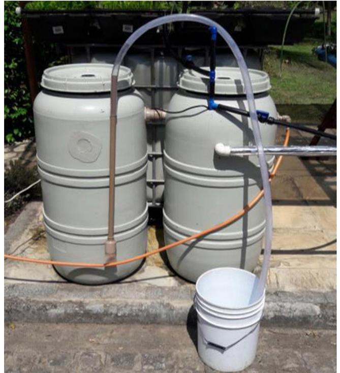
Figura 19. Material utilizado no sifonamento de detritos decantados na base do filtro decantador e do filtro biológico.
