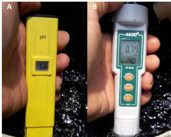
**Figura 18.** Medidores de pH (A) e de condutividade elétrica (B) portáteis de baixo custo facilmente encontrados em lojas que vendem produtos para hidroponia.
