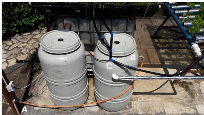
**Figura 3.** Vista externa do filtro biológico: A) toneira e mangueira para reposição da água. B) orifício para instalação de flange de 20 mm e boia para controle automático da água de reposição; C) orifício de passagem da mangueira e fiação elétrica da bomba d'água instalada no filtro biológico.
