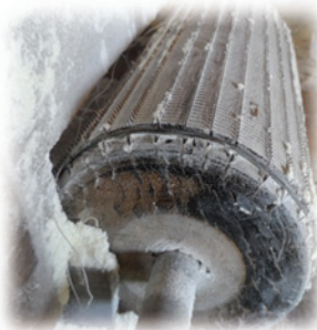
Caititu – equipamento utilizado nas etapas de trituração das raízes e da massa prensada.
