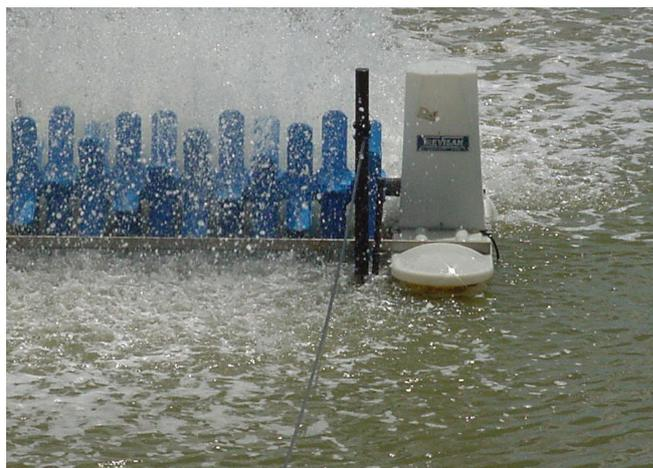
**Foto 5.** Detalhe de um aerador de pás em funcionamento. Foto: Julio F. Queiroz.
