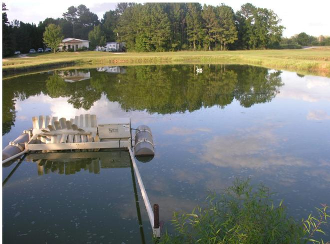
**Foto 1.** Aerador mecânico posicionado de maneira correta em um viveiro de piscicultura na Fisheries Station, Auburn University, AL, USA. Foto: Julio F. Queiroz.
