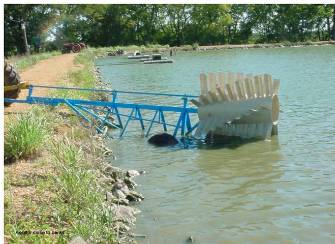
**Foto 3.** Detalhe de aerador com eixo motriz acoplado a trator em uma fazenda de produção de catfish – bagre do canal – em Greensboro, AL, USA. Foto: Julio F. Queiroz.
