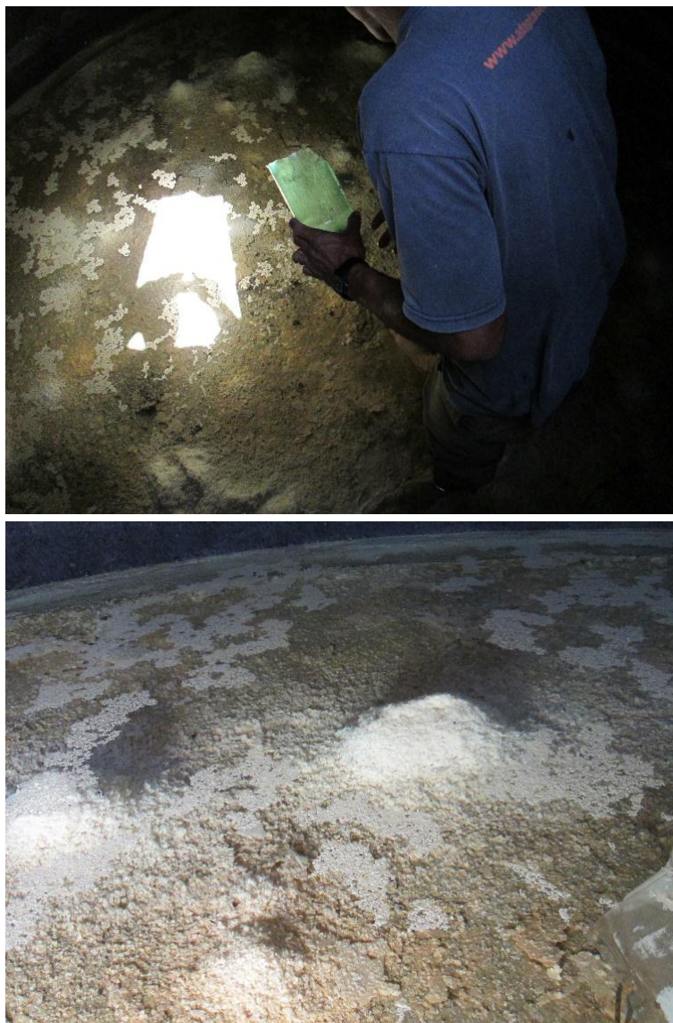
Figura 5. Produtor no reservatório onde os sais precipitaram após seis meses de tratamento com um catalizador eletroquímico. A direita o sal precipitado no reservatório em detalhe.
