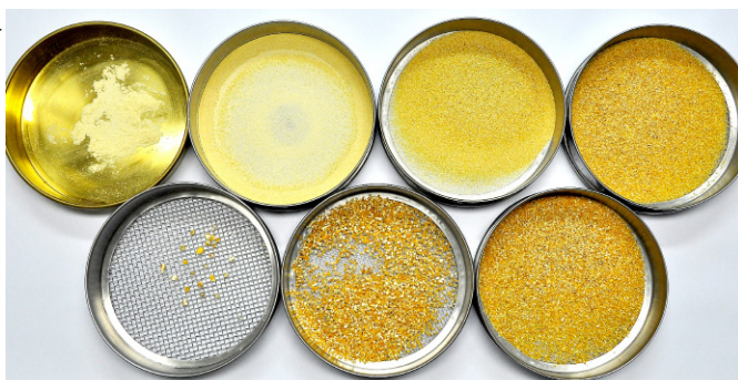
Figura 10. Peneiras contendo as respectivas frações da sub-amostra retida.
