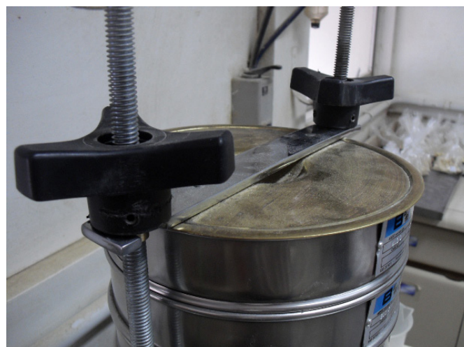
Figura 8. Fixação da tampa do conjunto de peneiras.
