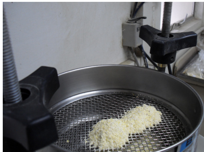
Figura 7. Transferência da sub-amostra para o topo do conjunto de peneiras.
