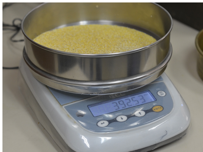
Figura 11. Pesagem de cada peneira com sub-amostra retida.
