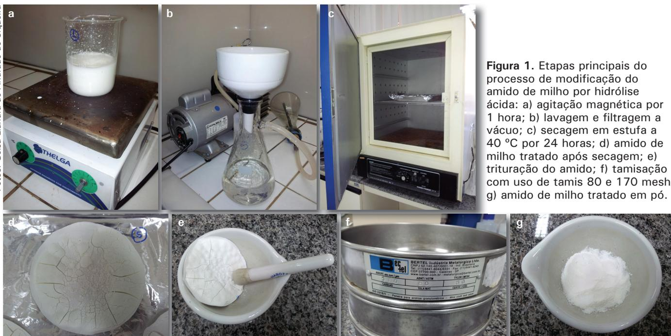
**Figura 1.** Etapas principais do processo de modificação do amido de milho por hidrólise ácida: a) agitação magnética por 1 hora; b) lavagem e filtragem a vácuo; c) secagem em estufa a 40 °C por 24 horas; d) amido de milho tratado após secagem; e) trituração do amido; f) tamisação com uso de tamis 80 e 170 mesh; g) amido de milho tratado em pó.
