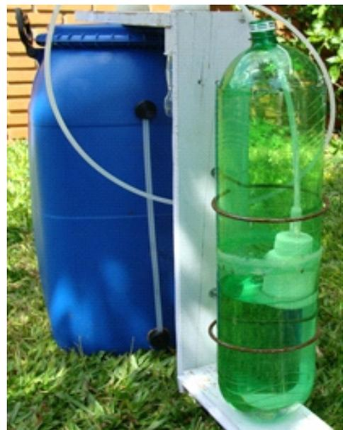
**Figura 6.** Vista do distribuidor de água do Irrigador Solar.
