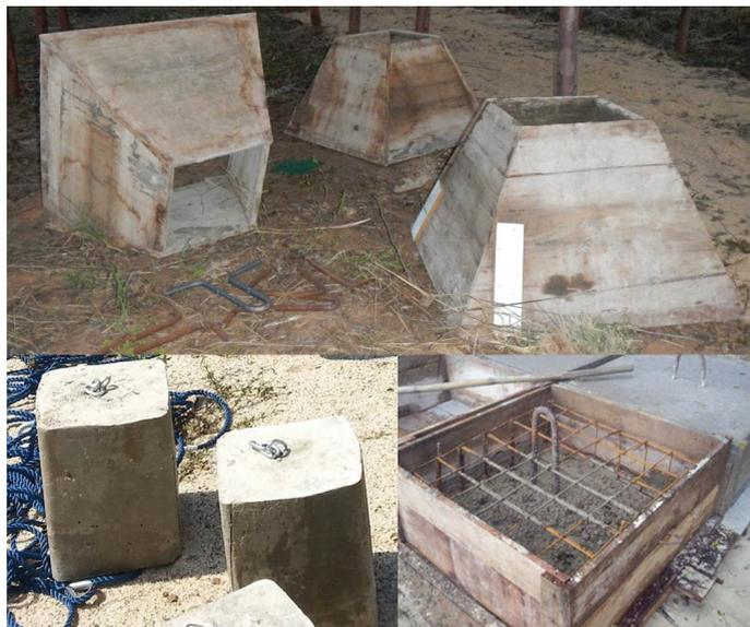
**Figura 5.** Moldes para poitas de concreto (acima); poitas de concreto de 18L (à esquerda) e molde de poita de concreto armado com ferragens (à direita). Fonte: Fotos acima e à esquerda: Daniele Evangelista. Foto à direita, retirada de [livrodefotosdeobrasqueexecutei.blogspot.com.br](http://livrodefotosdeobrasqueexecutei.blogspot.com.br).
