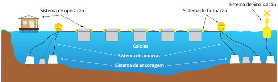
Figura 1. Representação esquemática do sistema de cultivo em tanque-rede.
